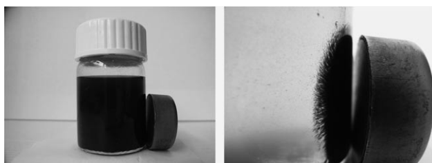
Abbildung 4. Magnetische Abtrennung fein verteilter superparamagnetischer katalytisch aktiver Nanopartikel (links: kurz nach dem Anbringen des Magneten; rechts: 2 min später).
